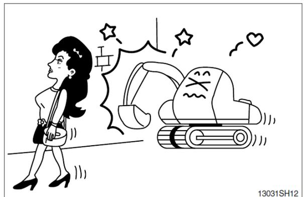
Brinde una ventilación suficiente si trabaja en un lugar cerrado con el motor encendido, para evitar intoxicarse con los gases del caño de escape.
