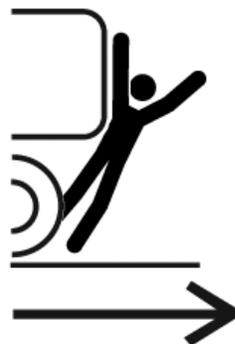
équipée pour savoir si des personnes se trouvent derrière la machine. Le système présente des limitations dues aux conditions d'entretien, à l'environnement et à sa plage de fonctionnement.
