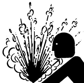
d'éliminer la pression du circuit hydraulique ou d'un accumulateur en desserrant un raccord.
