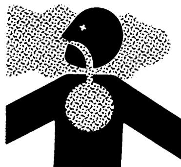
Ne pas utiliser de solvant chloré sur les zones où un soudage sera effectué.
