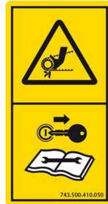
**Position :** Sur l'accumulateur de pression hydraulique
