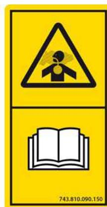
**Position :** Sous le capot, à côté du vase d'expansion de liquide de refroidissement
