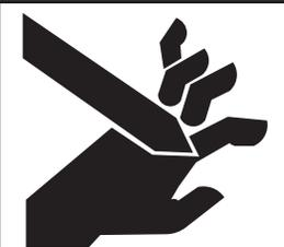
Éviter tout risque de blessure par suite de happement. Arrêter le moteur et retirer la clé avant d'ouvrir les trappes de nettoyage.
