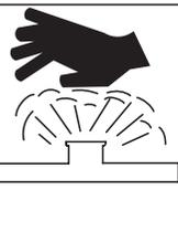
Circuit de refroidissement sous pression. Pour éviter les brûlures causées par le relâchement incontrôlé de vapeur et de liquide de refroidissement brûlant:
