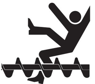
Éviter tout risque de blessure ou de mort par suite de happement. Ne pas monter dans la trémie lorsque le moteur tourne.
