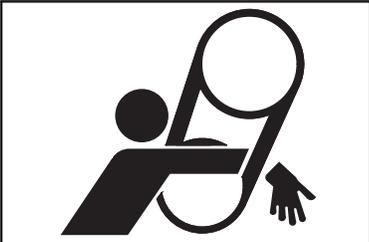
Éviter tout risque de blessure par suite de happement. Ne jamais relever un dispositif de protection lorsque le moteur est en marche. Arrêter le moteur et retirer la clé de contact.
