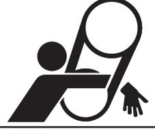
Éviter tout risque de blessure par suite de happement. Ne jamais relever un dispositif de protection lorsque le moteur est en marche. Arrêter le moteur et retirer la clé de contact.
