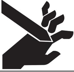
Éviter les blessures que risquent de causer les pièces rotatives du ventilateur ou du tamis. Arrêter le moteur et retirer la clé de contact avant d'ouvrir la porte du tamis rotatif.
