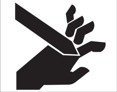
Éviter les blessures que risquent de causer les pièces rotatives du ventilateur ou du tamis. Arrêter le moteur et retirer la clé de contact avant d'ouvrir la porte du tamis rotatif.
