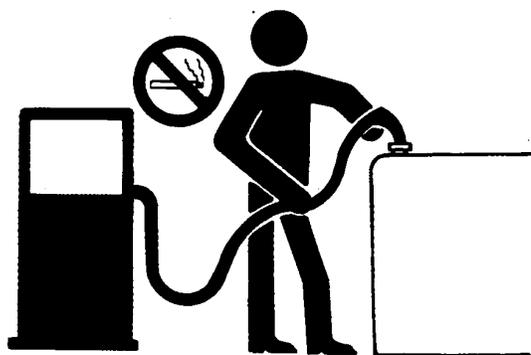
емкости следует коснуться пистолетом заправочной колонны топливную емкость. При заправке топливом пистолет заправочной колонны должен касаться заливной горловины топливной емкости.
