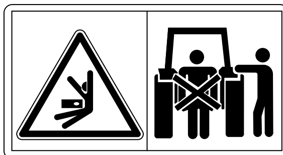
A—Etichetta interruttore di comando esterno sollevatore anteriore
