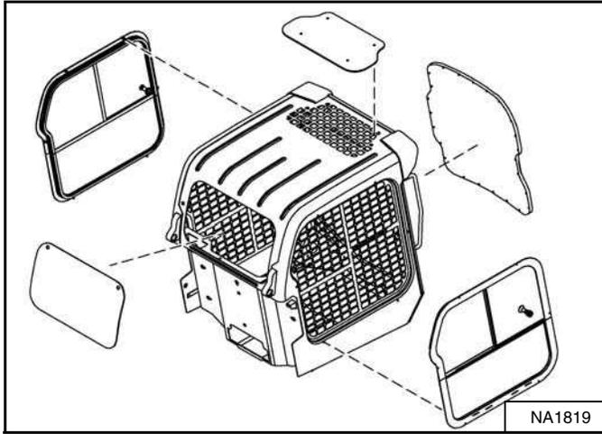
Disponível para aplicações especiais para evitar a entrada de detritos e objetos arremessados na cabine. O kit inclui porta dianteira policarbonato laminado de 19,1 mm (0.75 pol.) de espessura, janelas laterais e janela traseira de policarbonato [Figura 6].
