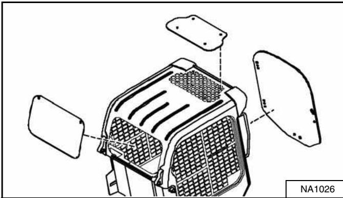
Disponível para aplicações especiais, para restringir a entrada de materiais pelas aberturas da cabine. O kit inclui porta dianteira de policarbonato de 12,7 mm (0,5 pol.) de espessura e janela traseira de policarbonato [Figura 5].
