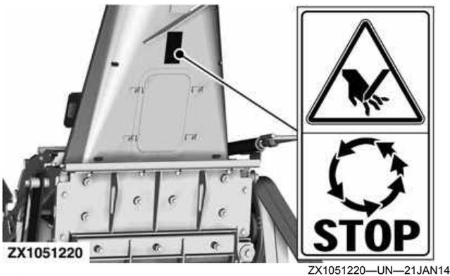
Éviter tout contact avec des pièces en mouvement de la machine. Attendre l'immobilisation complète de toutes les pièces en mouvement.
