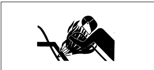
Des vaporisations et brouillards inflammables peuvent se dégager si l'on chauffe près de conduits sous pression, présentant un risque de brûlures graves pour l'opérateur et les personnes à proximité. Ne pas chauffer en soudant ou en utilisant un chalumeau à proximité de conduits hydrauliques sous pression ou de matières inflammables. Les conduits sous pression risquent d'être accidentellement coupés par la propagation de la chaleur.
