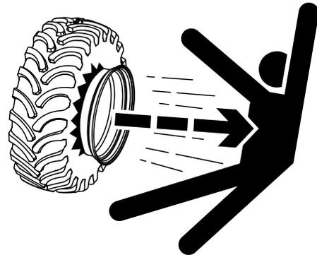
Verifique as rodas quanto a baixa pressão, cortes, bolhas, aros danificados ou parafusos e porcas faltando.
